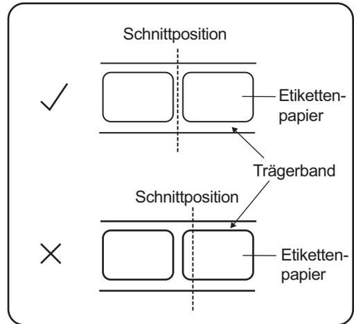
**Schnittposition für Etiketten mit perforierter Linie**
