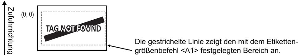
Sofern nicht durch den Etikettengrößenbefehl <A1> festgelegt, druckt der Drucker den RFID-Fehler in einer Größe von 30 x 40 mm (Länge mal Breite). Wenn ein Zeichen mit dem Schrägstrich überlappt, wird das Zeichen von Schwarz in Weiß umgekehrt.
