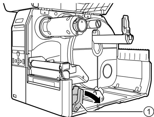
**4** Entnehmen Sie Etikettenpapier und Farbband, falls diese bereits eingelegt sind sind.
