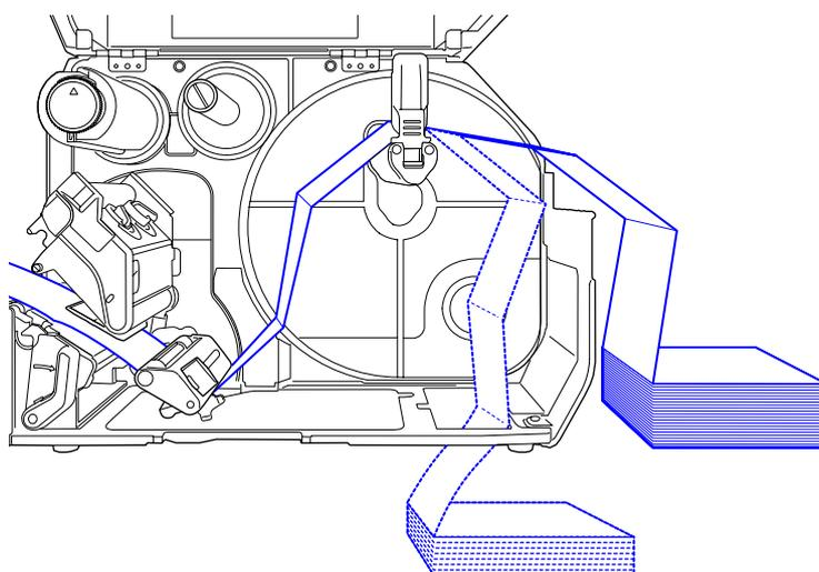
— Einlegen des Etikettenpapiers von der Rückseite des Druckers
