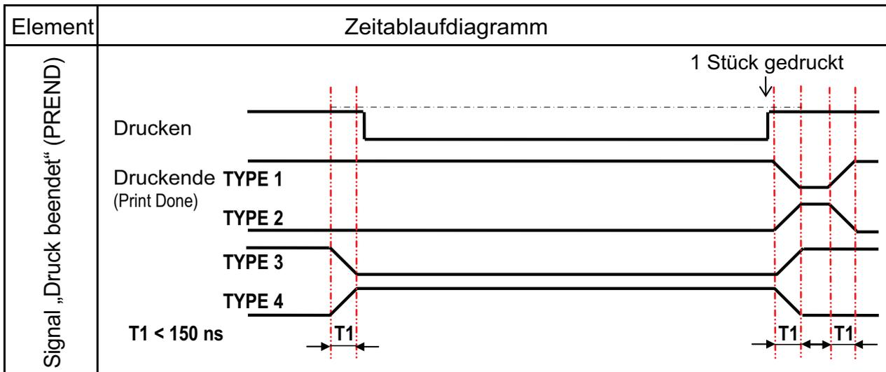
Die Anstiegs- oder Abfallzeit ( $T1$ ) des Signals „Druck beendet“ beträgt weniger als 150 ns. Sie müssen die Zeit berücksichtigen, wann das Signal von den angeschlossenen Geräten ausgegeben wird.
