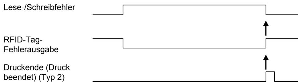
Wenn der Zähler für erneutes Drucken die festgelegte Anzahl erreicht hat, werden gleichzeitig der RFID-Tag-Fehler und Gerätefehler ausgegeben. Der Gerätefehler ist immer ein langer Impuls.
