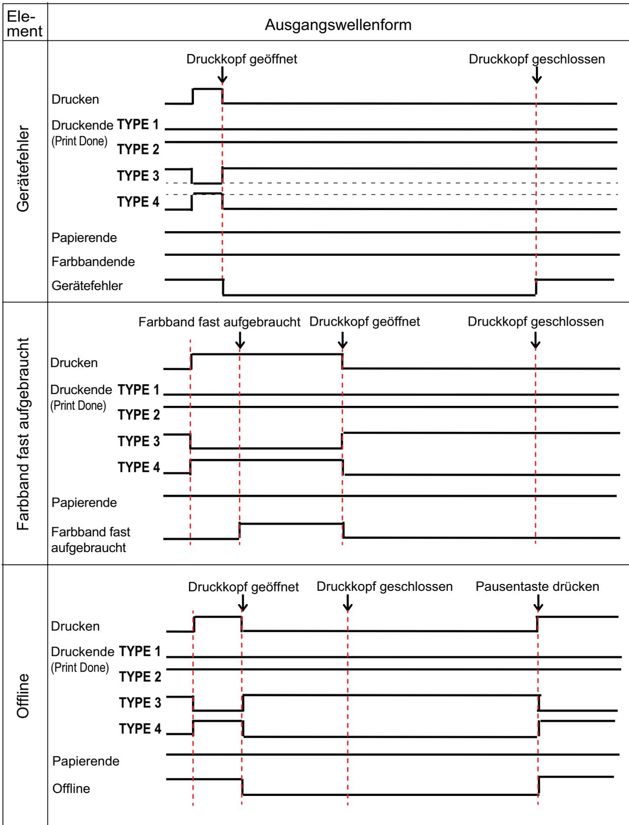
**Zeitablaufdiagramm (Wartesignal für Abschluss der Etikettenausgabe)**
