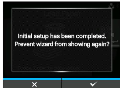
Wenn Sie eine der Softtasten drücken, führt der Drucker das Etikettenpapier automatisch zu (zur Druckkopposition) und wechselt in den Online-Modus.
