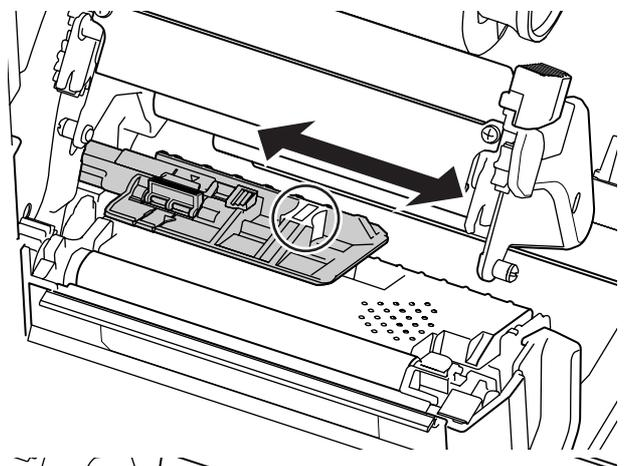
Der I-Marken-Sensor befindet sich unter der Markierung □ und der Lückensensor unter der Markierung ▽.
