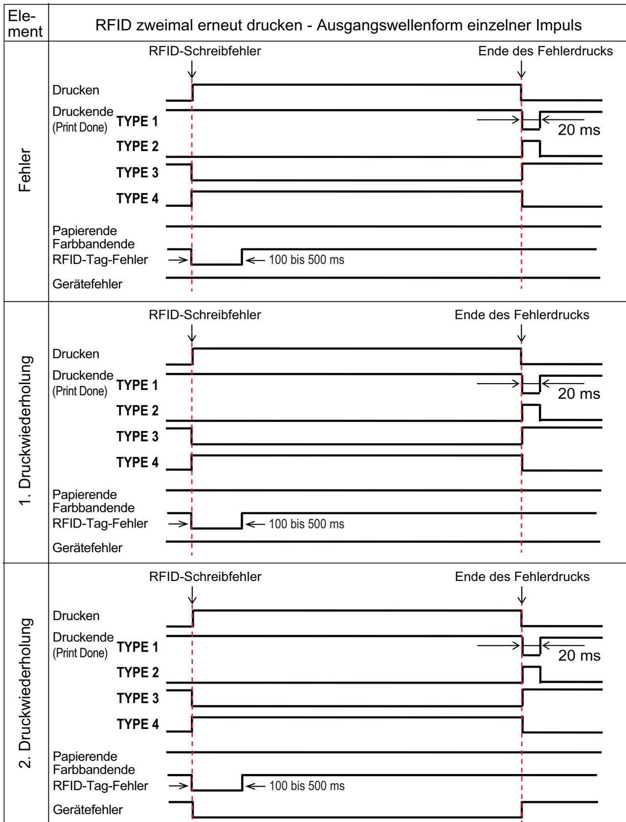
**Zeitablaufdiagramm der Fehlersignalausgabe mit langem Impuls**
